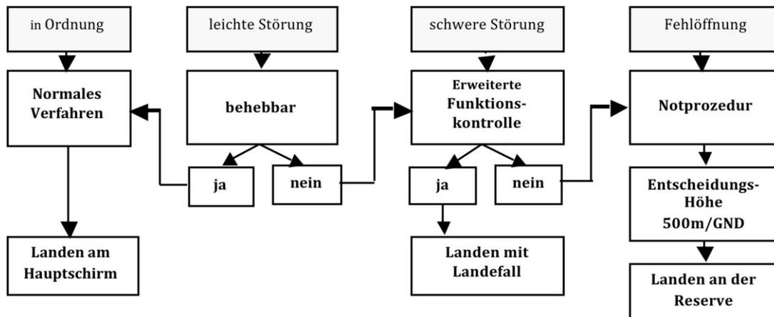
Prinzip der erweiterten Funktionskontrolle bei leichten bzw. schweren Störungen:
